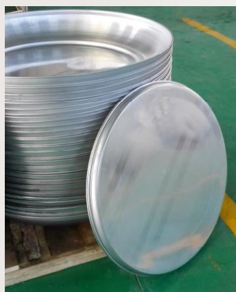
斜流风机，使用圆板旋压成型
